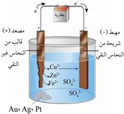
الشكل (20): تنقية النحاس بالتحليل الكهربائي.
