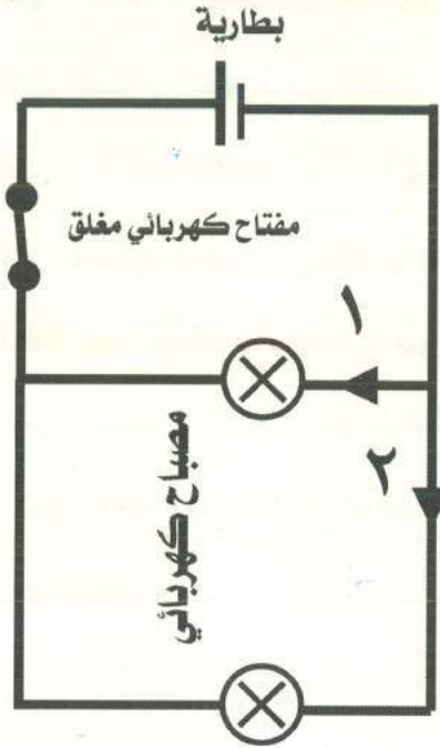
رسم مخطط الدائرة الكهربائية على التوازي
