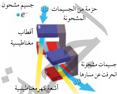
الشكل (10): إنتاج أشعة كهرومغناطيسية في مسارع السينكروترون.
