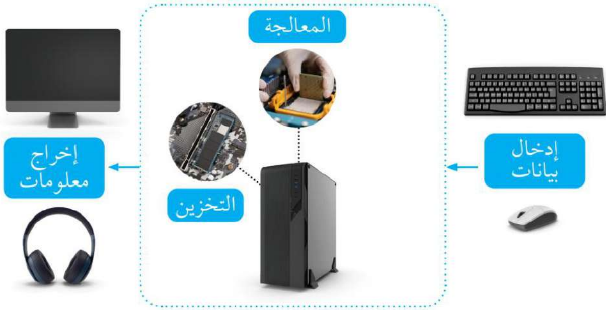
الشكل (1-1): رسم توضيحي لمبدأ عمل جهاز الحاسوب.
