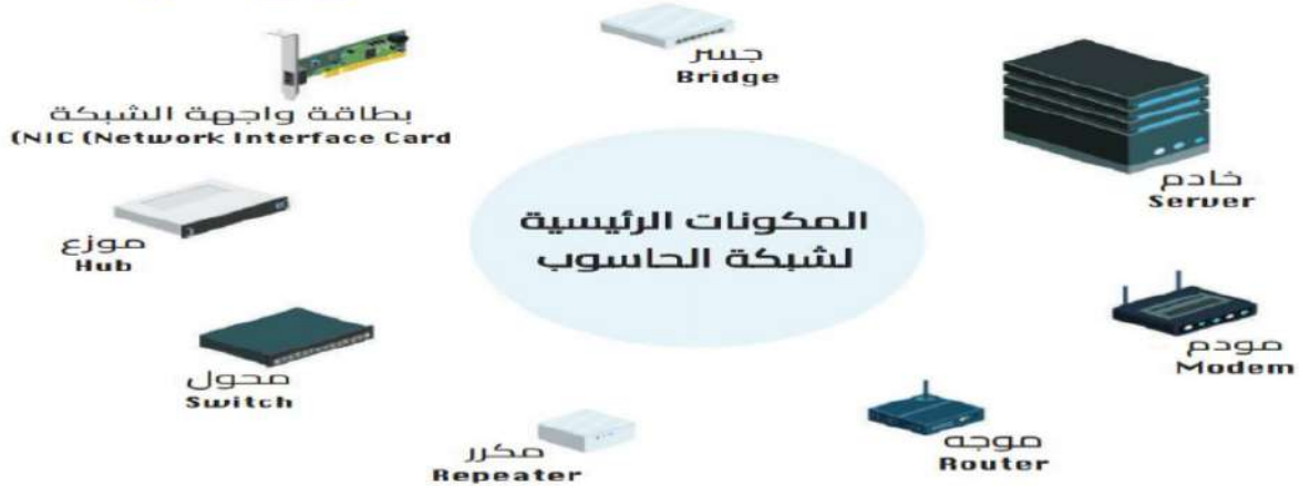
الشكل (1-2): مُكوّناتُ شبكة الحاسوب
