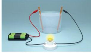
توصيل محلول هيدروكسيد الصوديوم للتيار الكهربائي
