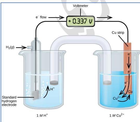
إذا كان قطب الهيدروجين المعياري (خلية مهبط) والفلز الآخر A مصعد، فإن أيونات الهيدروجين تُختزل إلى غاز الهيدروجين ويتصاعد من المحلول، فنقول الفلز A يحرر غاز الهيدروجين من محلول الحمض المخفف، مثاله: قطب الخارصين
