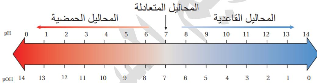
الشكل (6): العلاقة بين الرقم الهيدروجيني والرقم الهيدروكسيلي.
