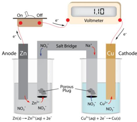
في مثال خلية Zn – Cu السابقة، لاحظنا ميل الخارصين للتأكسد أكثر من ميل النحاس بناء على سلسلة النشاط الكيميائي، أحدهما يميل للتأكسد وآخر يميل للاختزال فتتولد نتيجة ذلك قوة دافعة كهربائية تدفع الإلكترونات إلى الحركة من المصعد إلى المهبط، ولهذه القوة الدافعة قراءة تظهر على الفولتميتر كما في الصورة تدل على سريان التيار الكهربائي،
