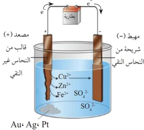
وضح مكونات وتفاعلات خلية التحليل الكهربائي لتنقية
