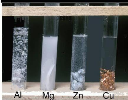
محلول حمض الهيدروكلوريك HCl (1M) شريط مغنيسيوم Mg، حبيبات خارصين Zn، حبيبات ألمنيوم، سلك نحاس Cu
