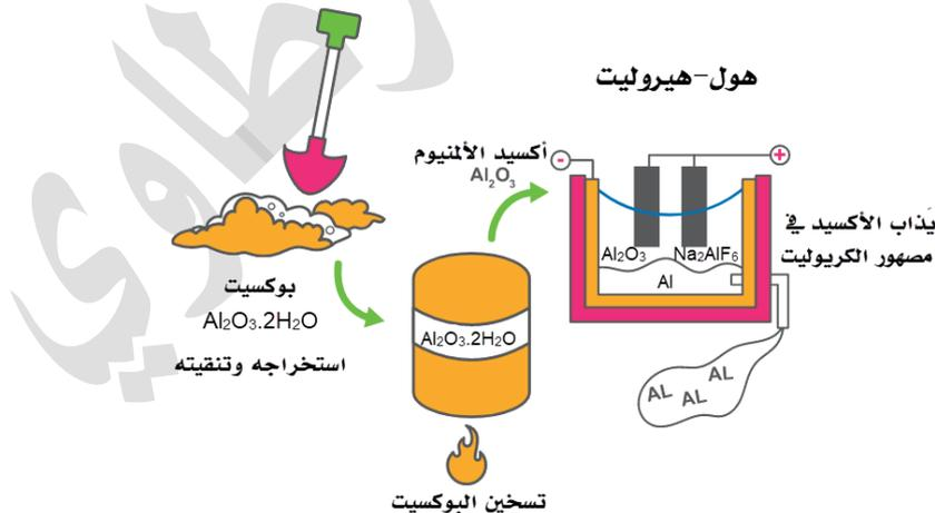
ماذا تُسمى خلية التحليل الكهربائي لمصهور  $Al_2O_3$ ؟ خلية هول-هيروليت
