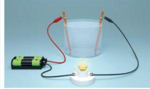
توصيل محلول الأمونيا للتيار الكهربائي
