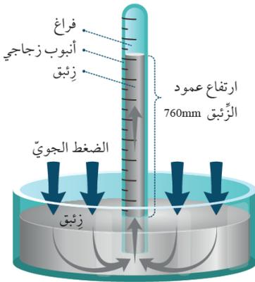
يتكون جهاز تورشلي من أنبوب زجاجي مغلق من أحد طرفيه، مفرغ من الهواء طوله تقريبا متر، ويقرب في مستودع فيه زئبق. يعمل ضغط الهواء على رفع الزئبق داخل الأنبوب الزجاجي، ويكون ارتفاع الزئبق هو قيمة الضغط الجوي الأولية حيث أن الضغط الجوي يعادل تقريبا وزن عمود الزئبق الذي يبلغ 760 mm.
