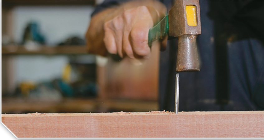
الشكل (17): للمطرقة طاقة حركية تُمكنها من بذل شغل على المسامير ودفعه في اللوح الخشبي.
