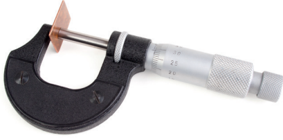
الشكل (3): قياس سُمْكِ صَفِيحَةٍ باستخدام الميكروميتر.
