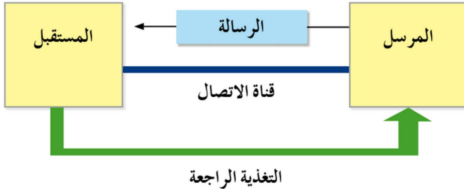
الشكل (٣-٤): المكونات الرئيسية لنظام التراسل.
