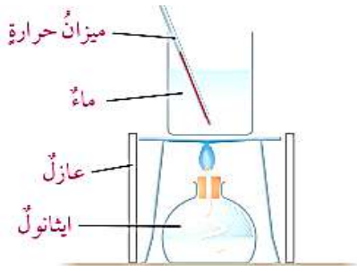
قياس الحرارة الناتجة عن احتراق الوقود.
