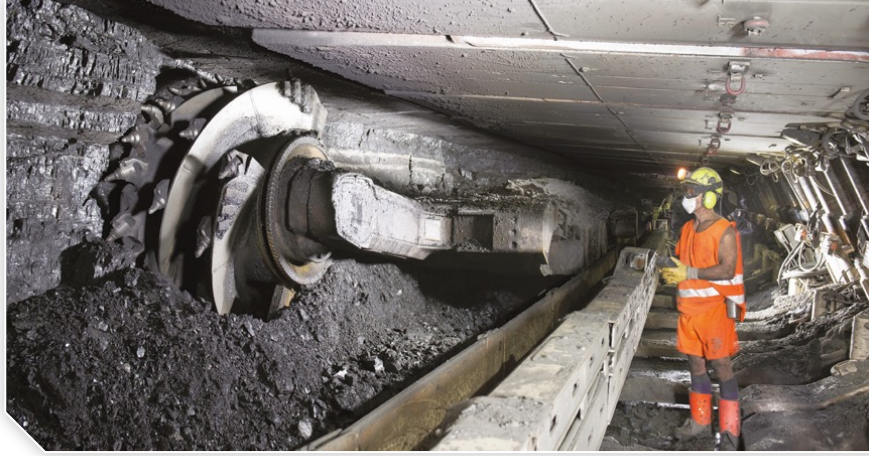
الشكل (15): استخراج الفحم الحجري باستخدام طريقة التعدين تحت السطحي.
